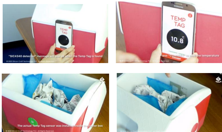
ภาพที่ 3.1 การทดสอบประสิทธิภาพของแอปพลิเคชันในอุณหภูมิต่ำ
