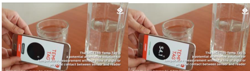
ภาพที่ 3.2 การทดสอบประสิทธิภาพของแอปพลิเคชันในอุณหภูมิสูง
